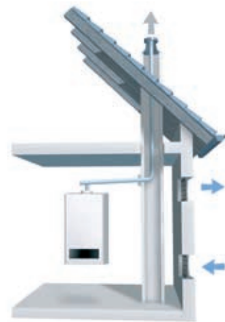
System kominowy z poborem powietrza z pomieszczenia, w którym zainstalowano kocioł grzewczy.
