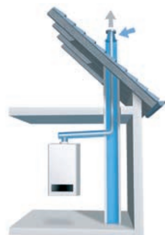
System kominowy z poborem powietrza do spalania z zewnątrz.
